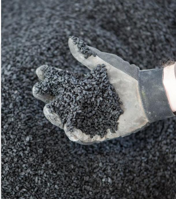
Im Recyclingprozess entsteht Plastik-Regranulat, aus dem zum Beispiel Kabelschutzrohre oder Putzmittelflaschen hergestellt werden.
